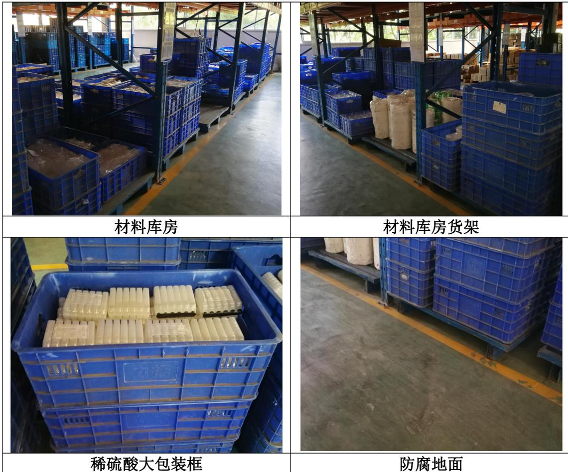
材料库房硫酸储存区硫酸采用塑料套包装防护，对于瓶装稀硫酸，硫酸瓶外面还套装了一个密封塑料袋，可防止瓶子中稀硫酸泄漏出来。区域存放有沙包 2 袋，氢氧化钠 20kg，以中和可能泄漏的硫酸，另备有水桶扫把、撮箕及拖布，可收集泄漏硫酸。
